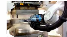
Pulverización del agente desmoldeante y/o limpieza del molde
